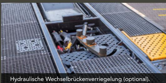
Hydraulische Wechselbrückenverriegelung (optional).
