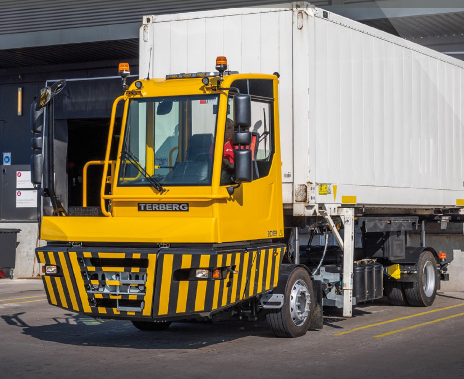
IDEAL ZUM RANGIEREN VON WECHSELBRÜCKEN • OPTIONALE SATTELPLATTE ZUR AUFNAHME
