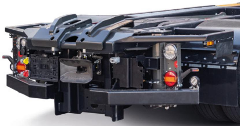
Luftgedeferte Einfahrwippe und Fangmaul mit Anhängerkupplung für Deichselanhänger (optional). Zugösen für 40 und 50 mm.
