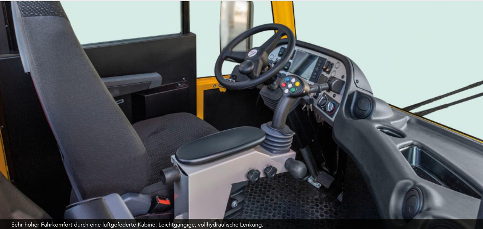
Sehr hoher Fahrkomfort durch eine luftgefederte Kabine. Leichtgängige, vollhydraulische Lenkung.
