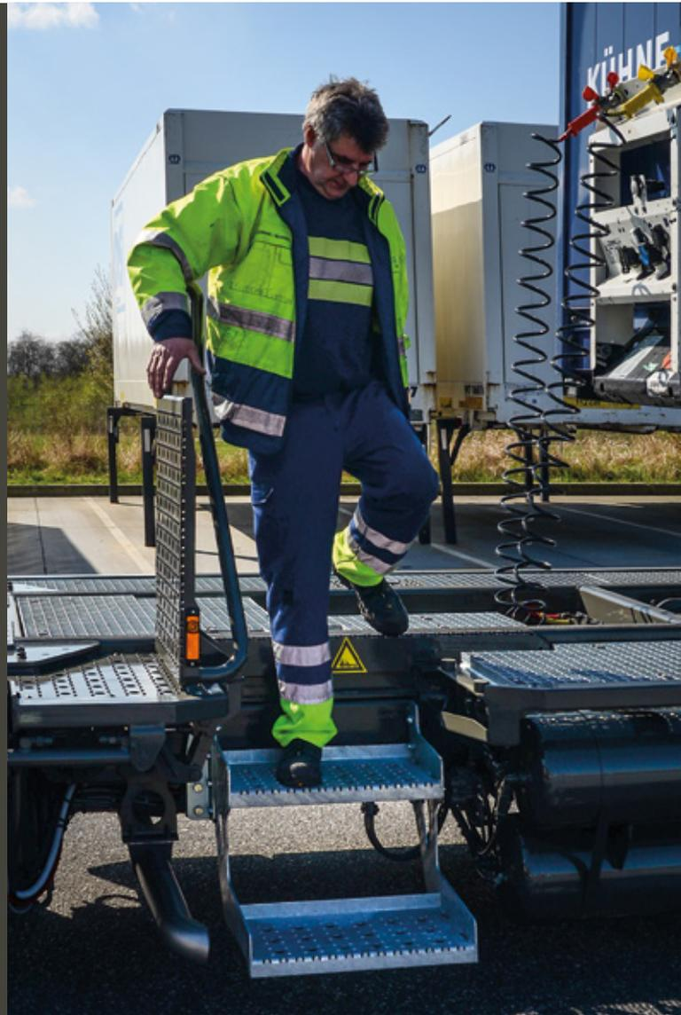
Hydraulisch ausklappbare Treppe auf Fahrerseite für den Trailerbetrieb. Aus Fahrerkabine heraus aktivierbar.
